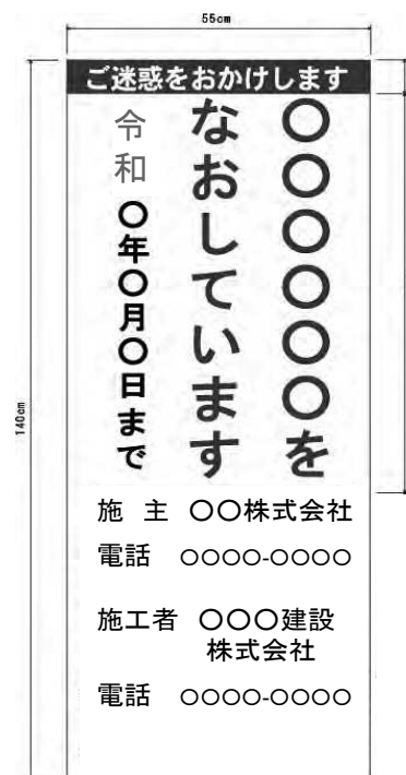
お知らせ看板B(施工中)
