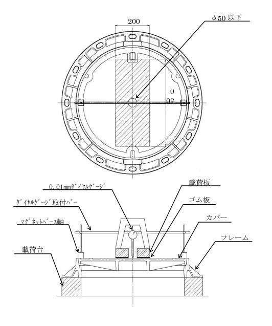
注)本要領図は試験治具の取付け方法及び位置関係を示すもので製品の形状とは 一部異なる部分がある。
