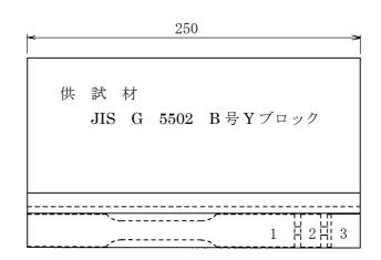
① 引張試験片 ② 硬さ試験片・黒鉛球状化率判定試験片 ③ 腐食試験片
